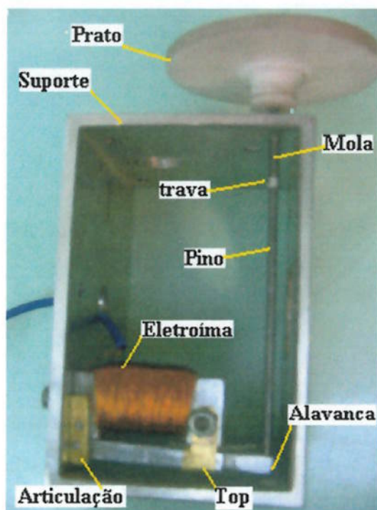
Figura 5.1.8 - Bancada experimental do mecanismo e do eletroímã da alternativa 4
